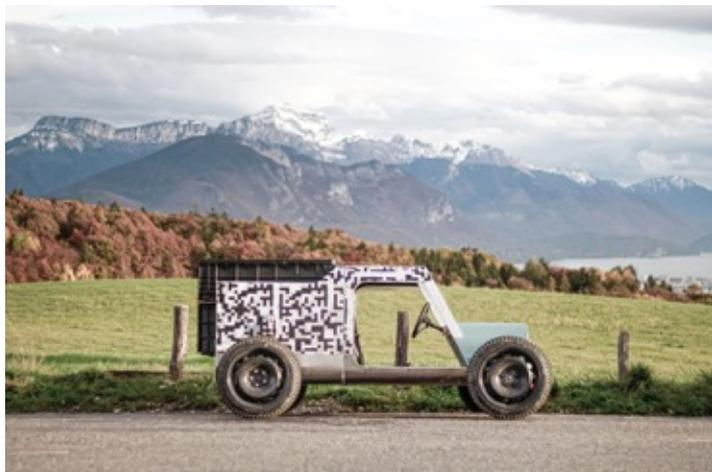
**La Bagnole (KG Auto)** réinvente le véhicule utilitaire et de loisir sous la forme d'un étonnant quadricycle électrique, "un jouet rationnel" misant sur un design épuré et sur l'économie de poids (283 kg). Il s'agit d'un pick-up 2 places autorisant jusqu'à 150 kg de marchandises et dont la benne peut être configurée à la demande. Avec une autonomie de 70 à 140 km (selon les options), elle est disponible en version sans permis (L6e) ou avec permis (L7e)
